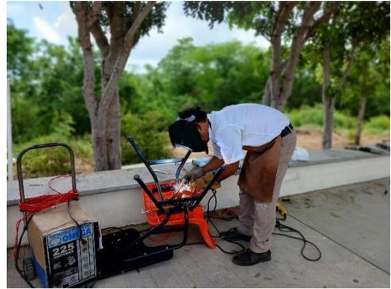
**Figura 60.** Soldadura de las butacas.
