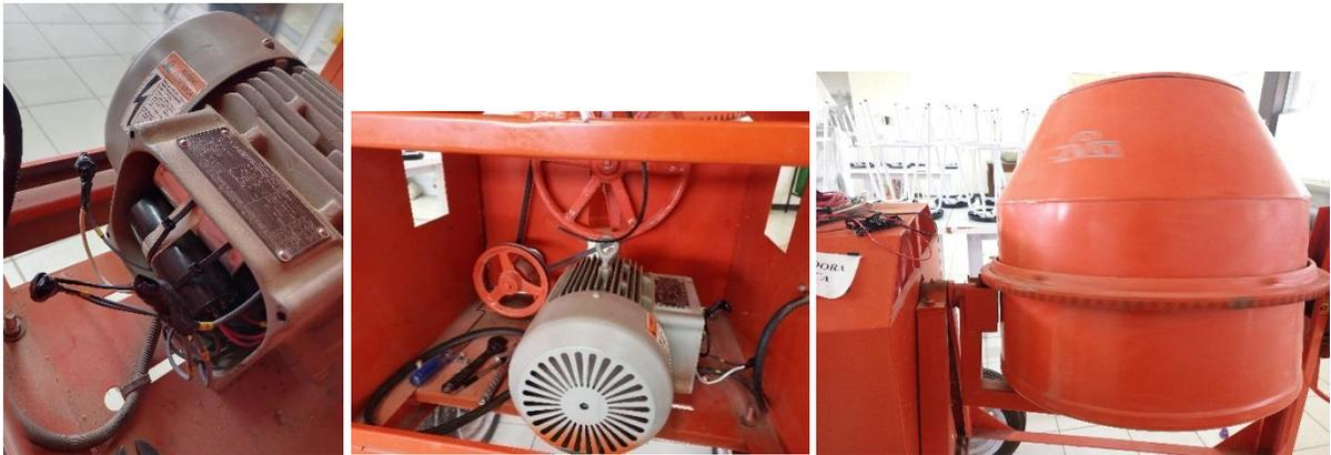
**Figura 64.** Mantenimiento de la revolvedora eléctrica del laboratorio de Ing. Civil.
